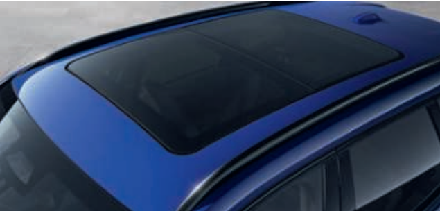
Exkluzivní leskle černé střešní ližiny M Shadow Line jsou základem pro střešní nosiče umožňující převoz například střešních boxů nebo jízdních kol.
