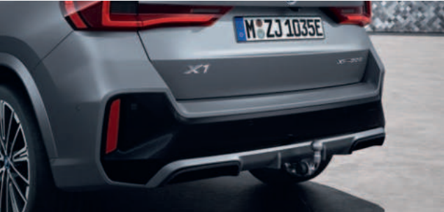
Tažné zařízení 2 s elektricky výsuvnou kulovou hlavici. Funkce stabilizace přívěsu a zabezpečení proti krádeži zvyšují bezpečnost.
